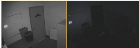
Geïntegreerde IR-verlichting van de Illustra met PoE-voeding: links in werking, rechts niet in werking.
